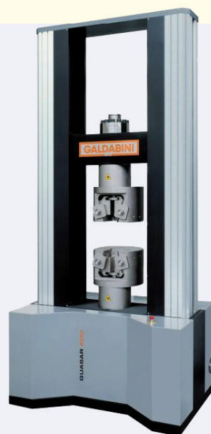
Padlótelepítésű berendezés pneumatikus befogófejjel
