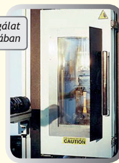
Szakítóvizsgálat 3 zónás kemencében
